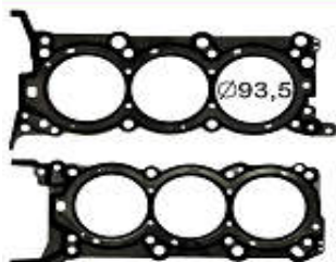
36803 SC - 1,20 MM - CIL. 93,5 MM 36803 MLS - 0,60 MM - CIL. 93,5 MM JUNTA CABEÇOTE
