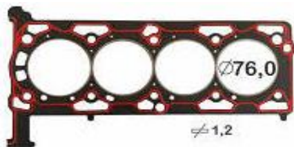
09802 SC - 1,2 MM - CIL. 76 MM 09802 MLS - 0,6 MM - CIL. 76 MM JTA CABEÇOTE
