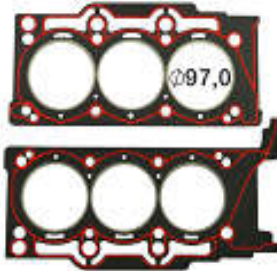
54404 SC - 1,00 MM - CIL. 97 MM 54404 MLS - 0,40 MM - CIL. 97 MM JUNTA CABEÇOTE
